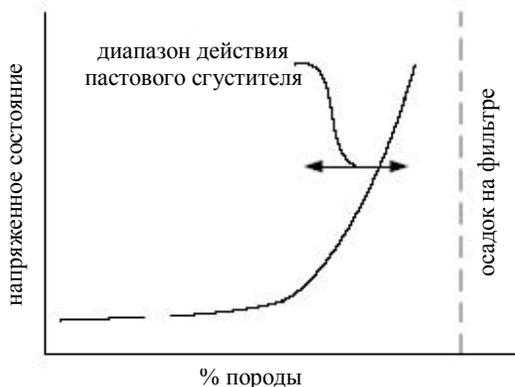
Рис.4. Кривая напряжения течения
