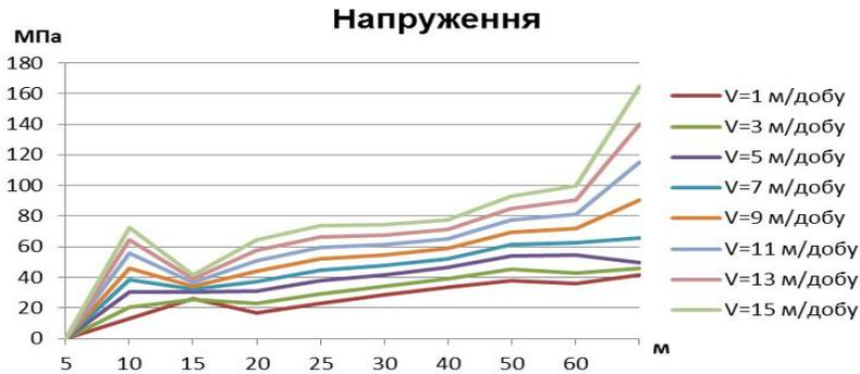
Рис. 6. Графік залежності зміни напружень від швидкості посування очисного вибою
